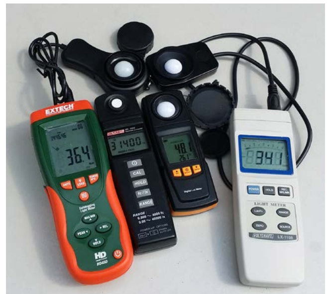
Abb. 2.2: Verschiedene Luxmeter. Die Messköpfe mit den Diffusorkalotten liegen möglichst nahe beieinander.
