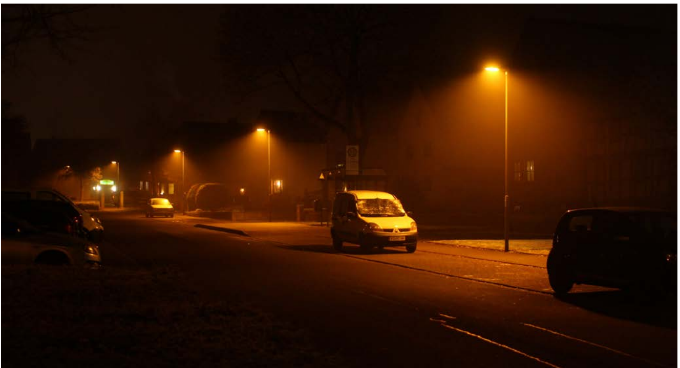
Abb. 1.6: Eine mit bernsteinfarbenen LED gleichmäßig beleuchtete Straße in der Rhön
