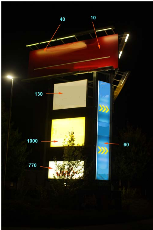
Abb. 3.11: Ein Pylon mit unterschiedlichen Werbetafeln und den gemessenen Leuchtdichten in \text{cd/m}^2 . Der gewünschte Informations- (oder Werbe-) Effekt könnte auch mit einheitlich niedrigen Leuchtdichten von etwa 100 \text{ cd/m}^2 vermittelt werden.
