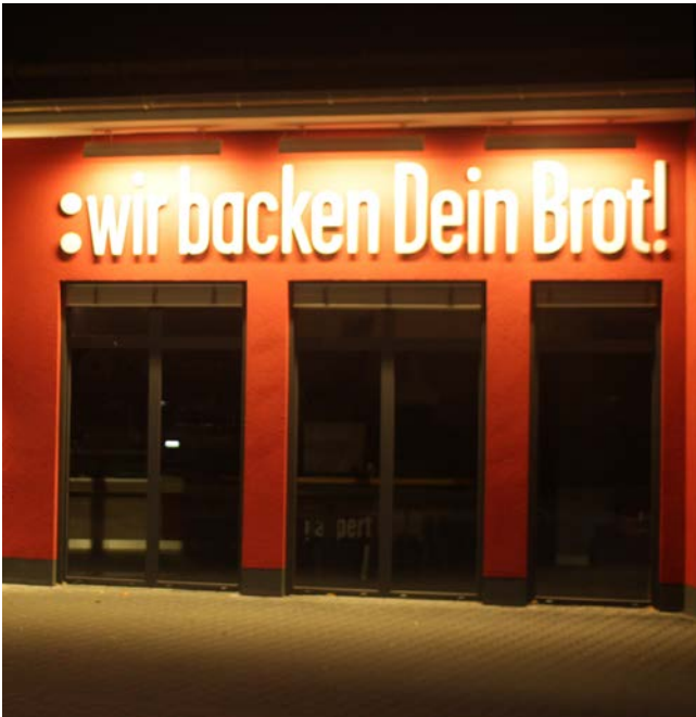
Abb. 3.19: Voll abgeschirmte Langfeldleuchten erhellen nur die darunter liegende Fläche und strahlen nicht in die Umgebung.
